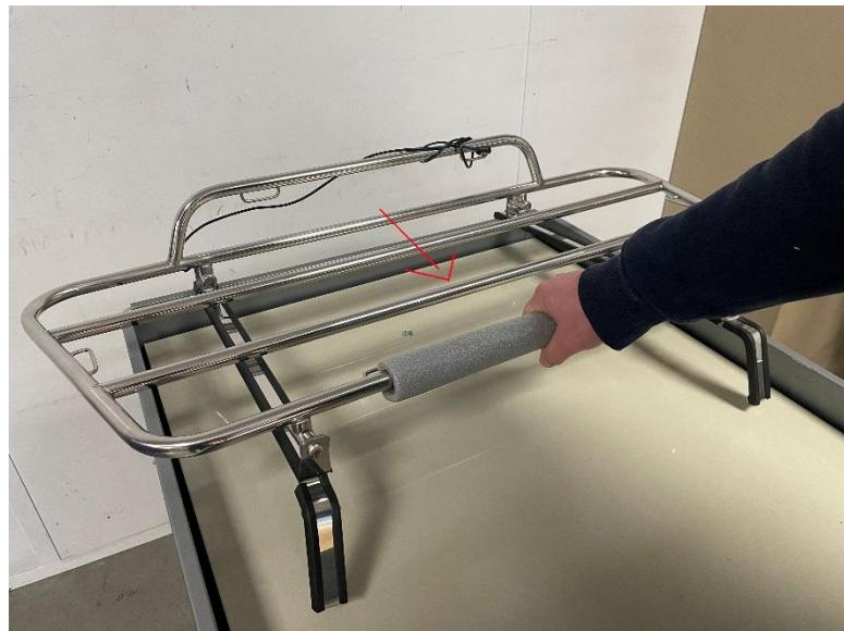
Lors de la pose de votre porte-bagages, faites un montage à blanc avec la malle entre-ouverte (avec une calle entre la malle et sa serrure) sans serrer les vis afin de conserver du jeu pour l'ajustement des pattes. Les pattes sont formées en biseau afin de s'ajuster à la courbure de la malle arrière, observez l'angle et positionnez-les en fonction sur le porte bagage.
