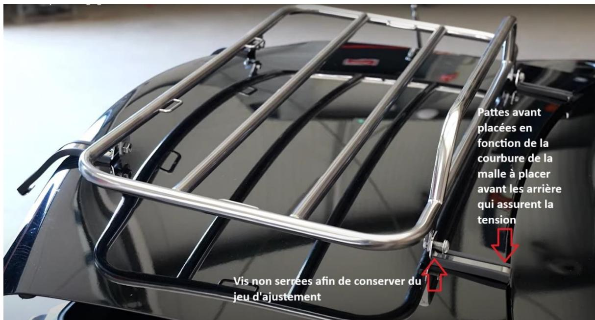
Une fois centré, positionnez d'abord les pattes côté avant du véhicule en prenant garde de ne pas marquer la peinture de la carrosserie. Il s'agit de simplement repérer son positionnement. Utiliser du ruban adhésif de masquage pour ce premier positionnement afin de protéger les bords.
