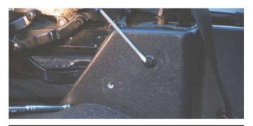
A l'aide du tournevis plat, soulevez la bague de l'écrou plastique, puis retirez-le.
