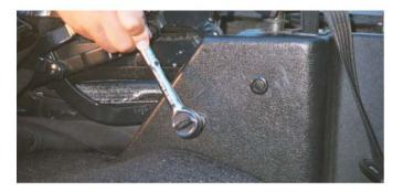
Retirez la vis de fixation inférieure.
