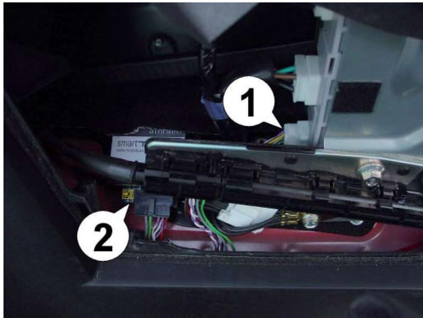
**4-** Branchez la prise de smartTOP (1) au contrôleur de la capote, puis connecter le module smartTOP au harnais.
