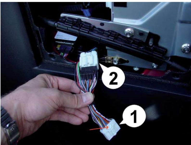
**3-** Pour une meilleure visualisation le mécanisme de verrouillage est représenté sur la fiche de smartTOP (1), marqué par une flèche.
