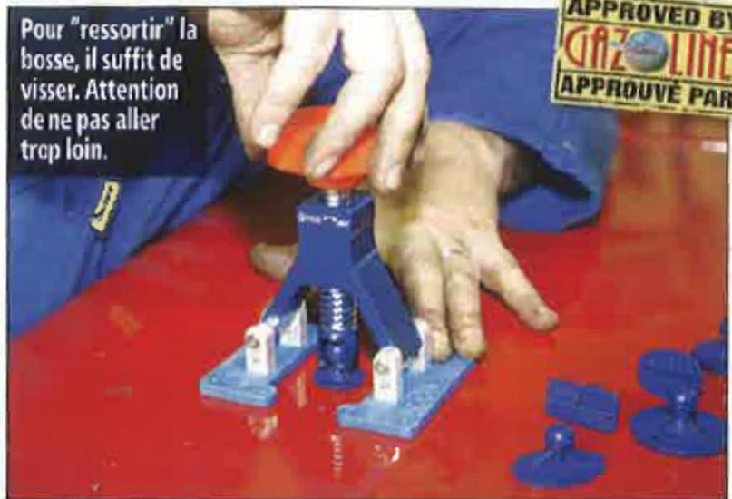
place l'extracteur au-dessus de la ventouse et on commence à visser. A mesure que l'on serre, la ventouse tire sur la tôle et diminue la bosse (attention de ne pas trop tirer pour ne pas sortir
